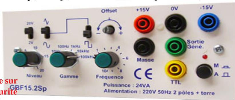
**Entrée et sortie sur douilles de sécurité**
