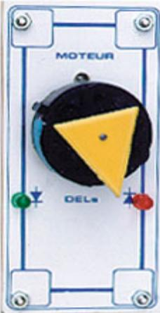
**Module 1 :** moteur continu (3 à 12V) et 2 DELs. L'axe du moteur est équipé d'un index de couleur permettant de visualiser le sens de rotation ainsi que 2 poulies autorisant des applications en génératrice.
