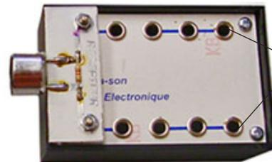
Douilles Ø4 pour sortie vers oscilloscope, etc.
