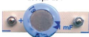
Condensateur polarisé (chimique) 1000μF (0,1mF) 25V.
