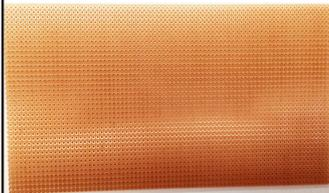
Plaquettes circuits imprimés percées en PASTILLES cuivrées. Pas 2.54 mm.
